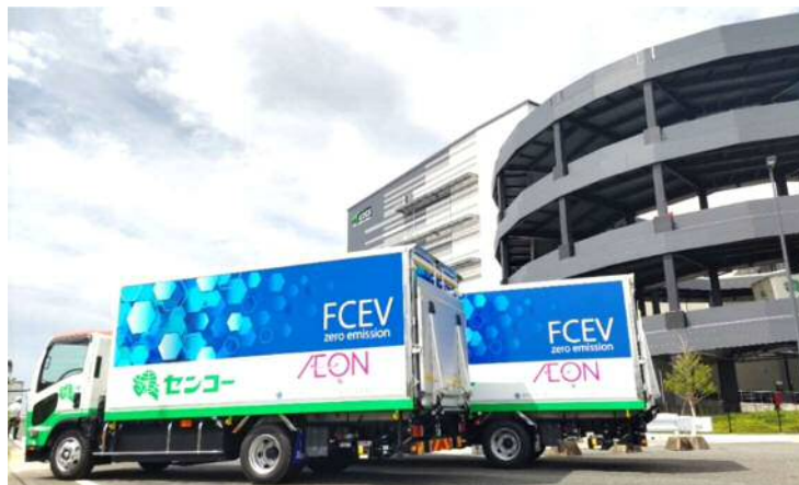
<走行時のCO 2 排出量がゼロで水素を燃料とする燃料電池車両> (福岡県 燃料電池トラック導入促進事業費補助金を利用)
